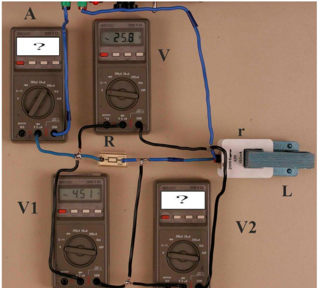
En el circuito de la figura, con un generador que suministra una frecuencia de 50Hz, una R (330 $\Omega$ ) en serie con una bobina de resistencia r de 43 $\Omega$  y coeficiente de autoinducción de 5,5H. Con los datos que se toman visualmente se podrá asegurar que:
