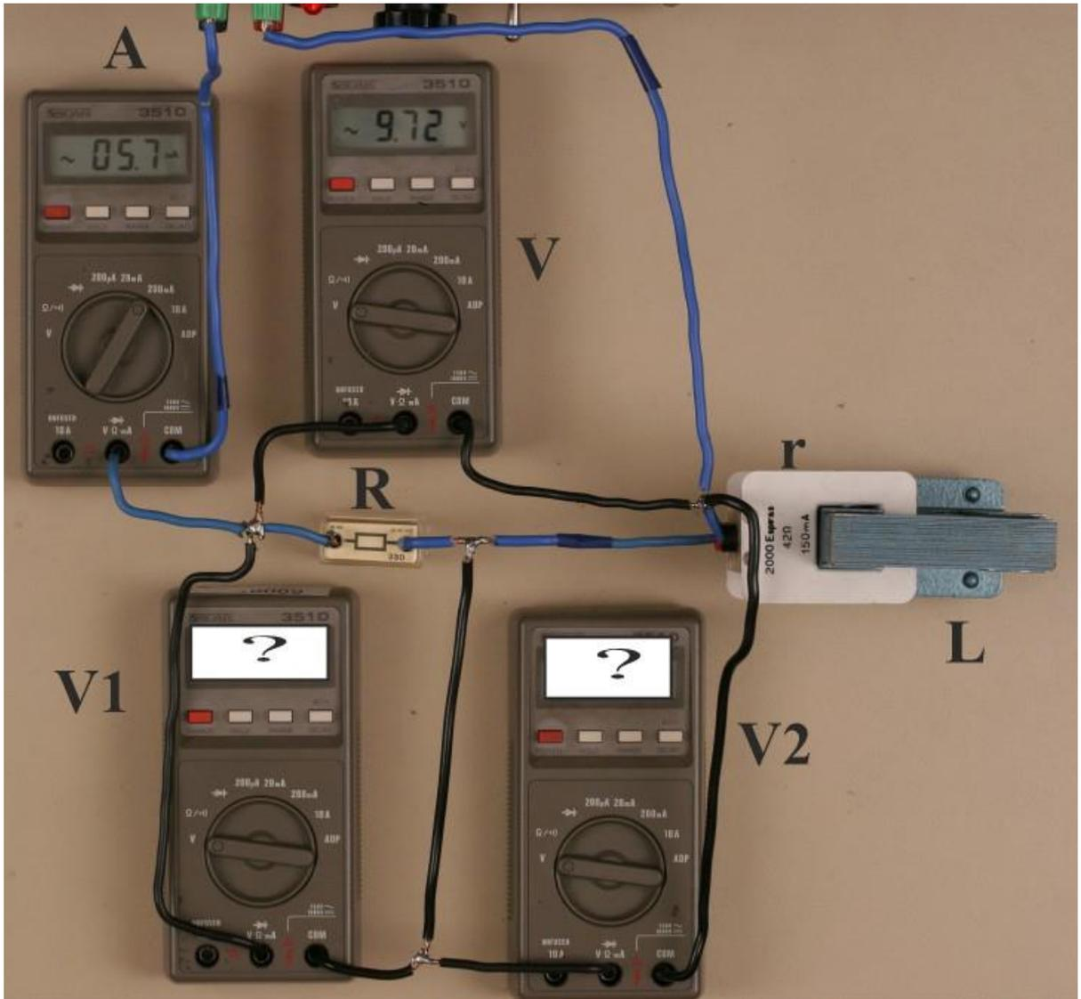
En el circuito de la figura, con un generador que suministra una frecuencia de 50Hz, una R (330Ω) en serie con una bobina de resistencia r de 43Ω, con los datos que se toman visualmente se podrá asegurar que:
