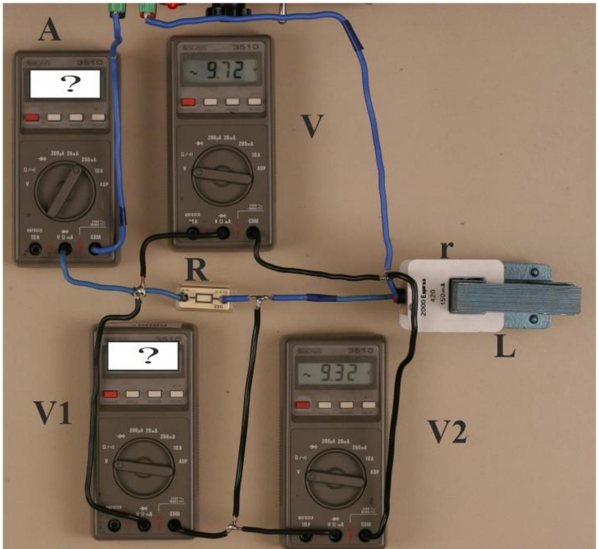
En el circuito de la figura, con un generador que suministra una frecuencia de 50Hz, una R (330 $\Omega$ ) en serie con una bobina de resistencia r de 43 $\Omega$  con los datos que se toman visualmente se podrá asegurar que:
