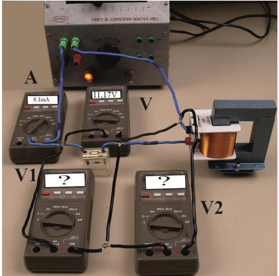
En el circuito de la figura, con un generador que suministra una frecuencia de 50Hz, una R (330Ω) en serie con una bobina de resistencia r de 43Ω con los datos que se toman visualmente se podrá asegurar que:
